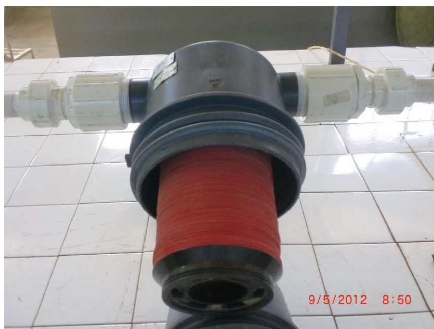
Figura 4. Filtro convencional de disco de 2 polegadas.
